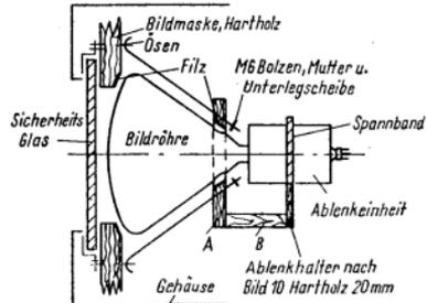
**Bild 11** Halterung für die große Bildröhre B 43 M 1
