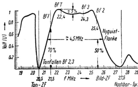
Bild 23 Durchlaßkurve des Bild-ZF-Teiles
