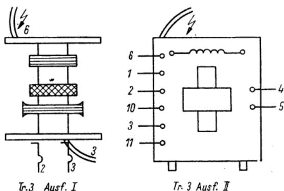
**Bild 21** Anschlußbezeichnungen von Tr 3, Ausf. I und II
