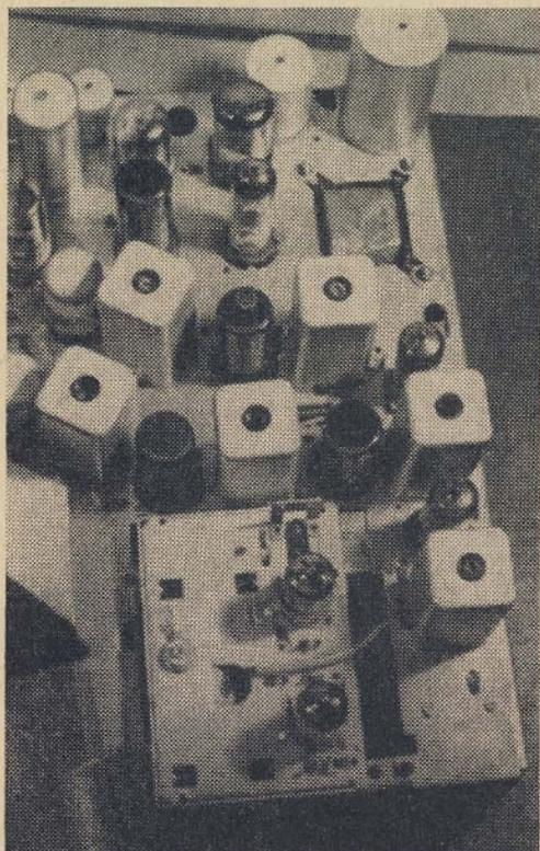
**Bild 14** Aufblick auf Chassis, HF- und ZF-Teile
