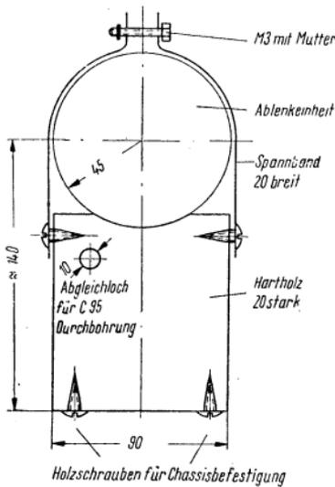
**Bild 10** Haltestütze für die Ablenkeinheit
