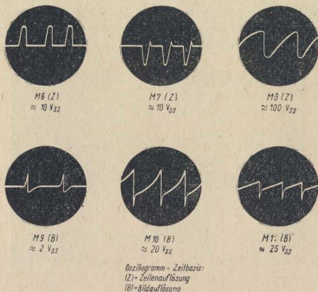
**Bild 28** Oszillogramme (Soll-Form) an den Meßpunkten  $M_6$  bis  $M_{11}$ . Die etwa vorhandenen Impulsspannungen sind angegeben;  $M_8$  und  $M_7$  müssen mit  $R_{76}$  und  $R_{78}$  auf gleiche Größe gebracht werden
