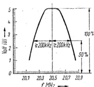
**Bild 24** Durchlaßkurve des Ton-ZF-Teiles
