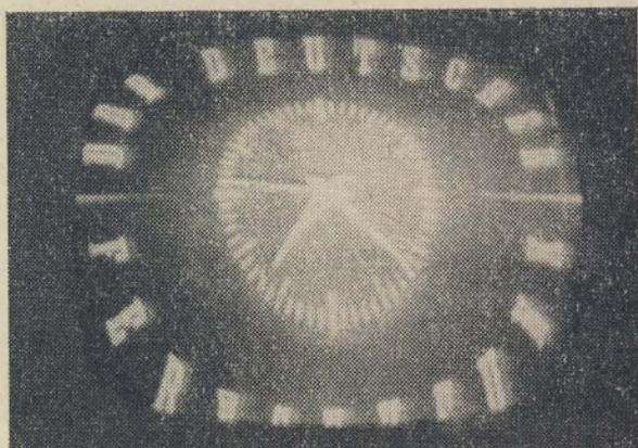
**Bild 31** Mangelhafte Bildlinearität (vertikal), Bildamplitude zu groß
