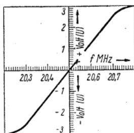
**Bild 25** Diskriminatorcurve des Ton-Demodulators
