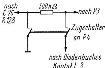
**Bild 3** Schaltvorschlag für NF-Umschaltung auf Diodenbuchse mit Zugschalter an  $P_4$
