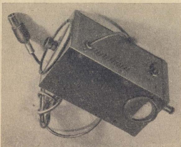
Bild 63. Ansicht des beschriebenen Grid-Dip-Meters
