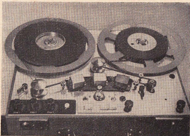
Bild 33. Ansicht des dreimotorigen Gerätes mit aufgelegten 1000-m-Tellern und eingelegtem Band – Die vier Steuertasten (Mitte vorn) betätigen von links nach rechts: Wiedergabe W, Rücklauf R (im Bild gedrückt), Vorlauf V, Stoptaste S
