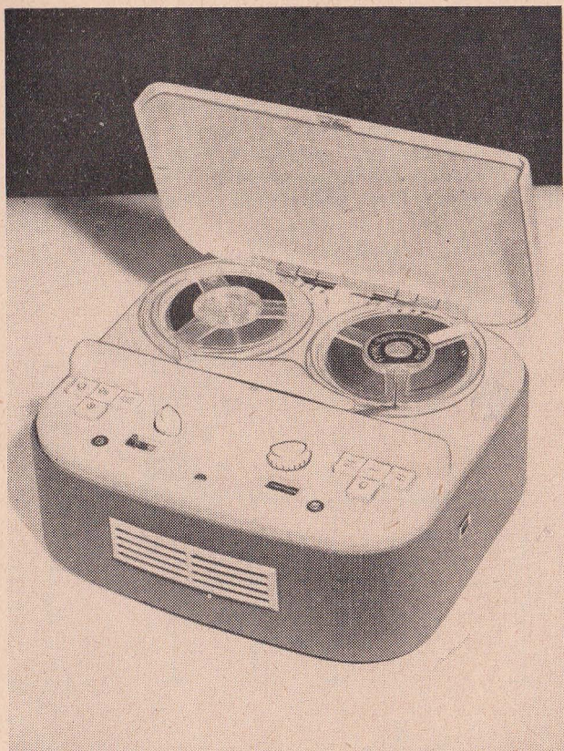
Bild 3 Tonbandgerät KB 100 (VEB Fernmeldewerk Leipzig). Ein modernes, selbständiges Bandgerät mit allen erforderlichen Zusatzeinrichtungen und Bedienungskomfort (Tricktaste, Bandzähluhr usw.) sowie mehreren mischbaren Eingängen (damit sind bereits einfache Tonmischungen, Überblendungen usw. möglich). Bandgeschwindigkeit umschaltbar: 9,5 und 4,75 cm/s Laufzeit maximal (Langspielband und 4,75 cm/s): 2mal 2 Std. Eingebauter Kontroll-Lautsprecher und Anschluß für Außenlautsprecher, Tonblende, Bandriß- und Endausschalter, Anschluß aller Mikrofonarten möglich. 5 Röhren. Schneller Vor- und Rücklauf. Alle Schaltvorgänge mittels Drucktasten
